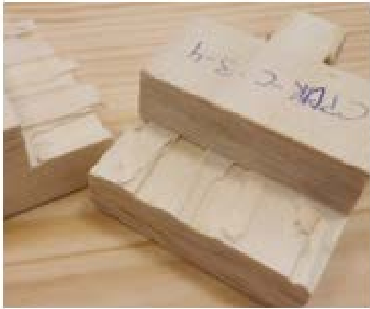
Figura 3. Fallo típico adherente de cada tipo de adhesivo. a) PUR. b) Bioadhesivo (LIG).
