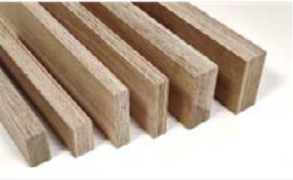
Figura 2. LVL de Eucalyptus globulus L. Figura 3. Radio mínimo de diseño instantáneo para láminas de 41 mm de espesor.
