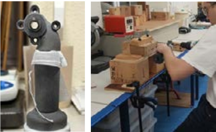
Figura 1: A la izquierda,detalle del dispositivo universal Woodex 2.1. A la derecha dispositivo acoplado al aspirador y en posición previa al taladrado
