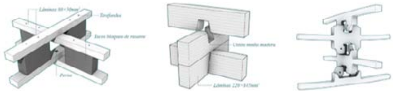
Figura 4. Sistemas de conexión en láminas reticulares de madera: (a) Savill Building; (b) Swatch Headquarters; (c) concepto propuesto.
