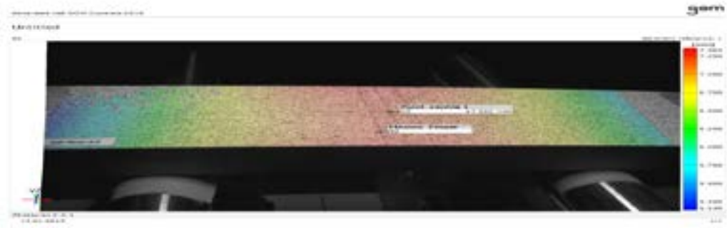
Figura 4. Campo de desplazamientos verticales en una probeta mediante DIC.
