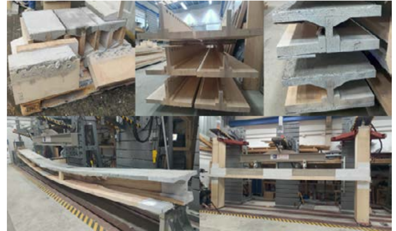
Figura 2. Estudio experimental de la solución mixta con tableros contrachapados de alma.
