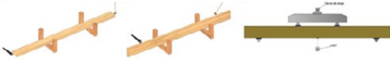
Figura 1. Ensayos mecánicos realizados: a) Ensayo NDT de resonancia longitudinal b) Ensayo NDT de resonancia transversal c) Ensayo de flexión a cuatro puntos.
