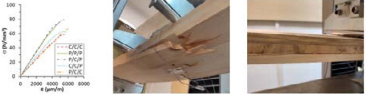
Figura 5. Comportamiento mecánico en ensayos de flexión de paneles CLT. a) Curvas \sigma – \epsilon medias por configuración. b) Rotura por tracción en lámina con nudo. c) Rotura por esfuerzo cortante
