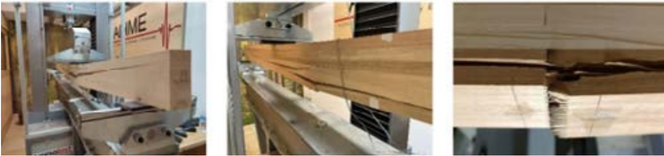
Figura 5. a) Rotura en viga monoespecia MC_C . b) Rotura en viga monoespecie de EG_C c) Rotura en viga multiespecie EG_MC .
