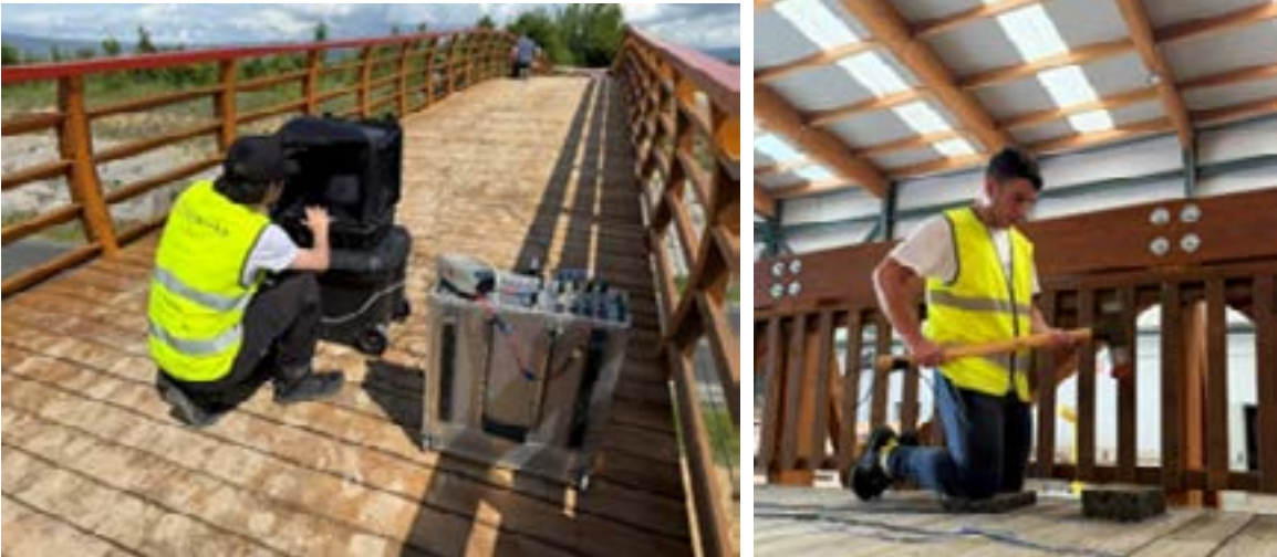
Figura 1. Realización de ensayos de AME sobre puentes de madera.
