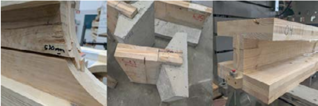
Figura 3. Estudio experimental del comportamiento de la solución mixta con tableros CLT.
