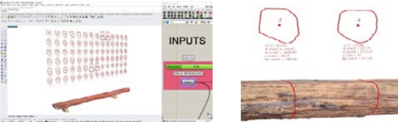
Figura 5. Implementación de la herramienta de obtención de sección y análisis geométrico desarrollada en Grasshopper 3D.
