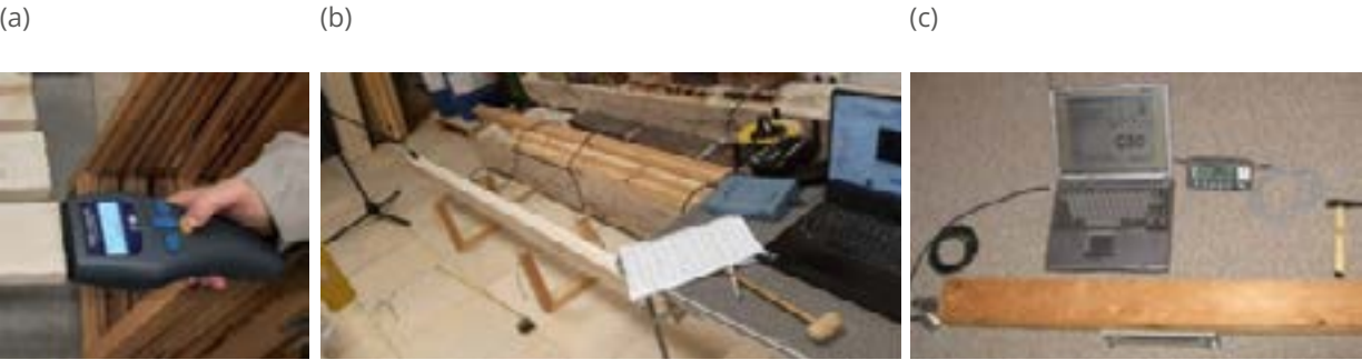
Figura 4. Dispositivos comerciales empleados para la clasificación de madera estructural. (a) MTG; (b) BING; (c) PLG.
