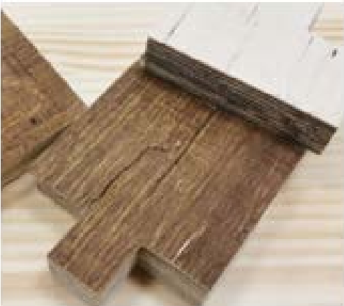
Figura 3. Fallo típico adherente de cada tipo de adhesivo. a) PUR. b) Bioadhesivo (LIG).
