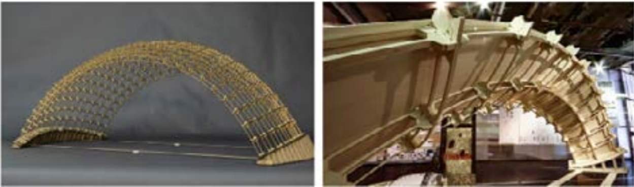
Figura 6. Prototipos realizados con mallado de LCP: (a) modelo reducido con superficie sinclástica; (b) modelo de 7.5 m con superficie anticlástica.
